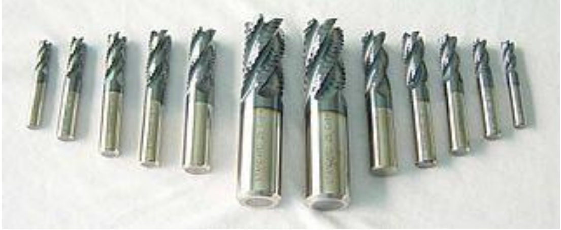
Şekil 4.1. Katodik ark yöntemi ile TiAlN kaplanmış delici takım uçları [43]
