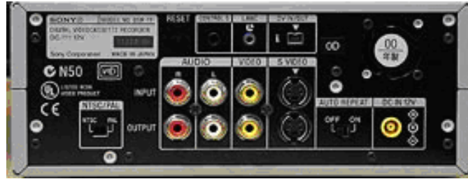
Resim 31: Kayıtcı teybin RCA ses ve DV bağlantı yeri
