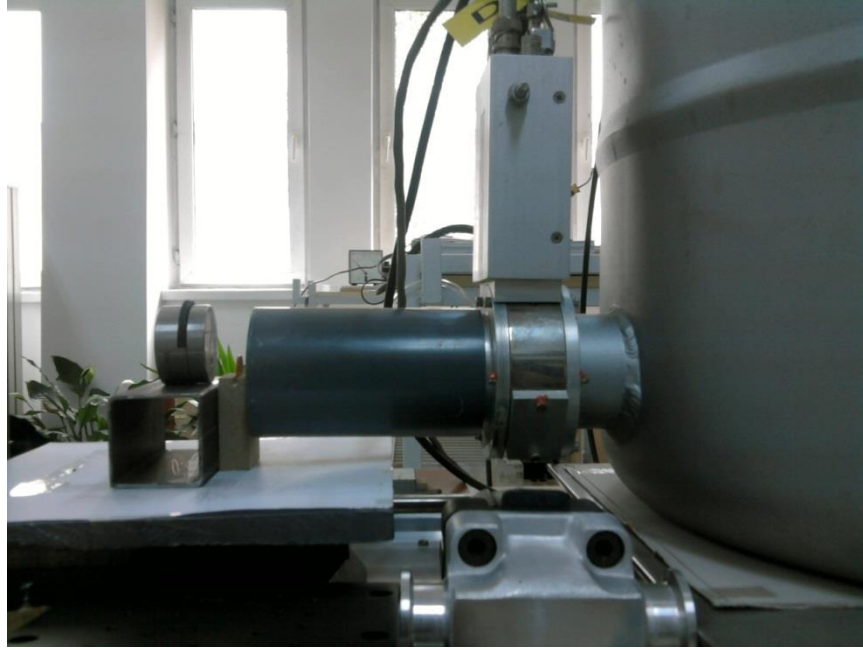
Şekil 3.3. HPGe dedektörün kullanıldığı deney düzeneği.
