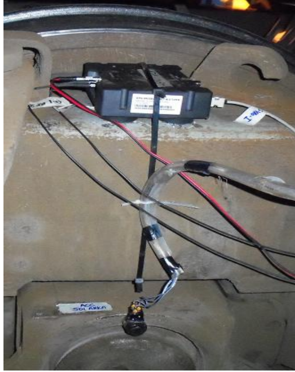
Şekil 5.10 : CAN-BUS Sync GYRO-IMU-GPS sistem ölçüm cihazı [24]
