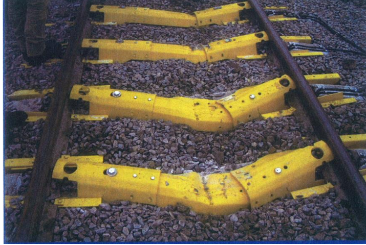
Şekil 2.5 : Traverslerin üzerine monte edilen kuvvet algılayıcı sensörler [13]
