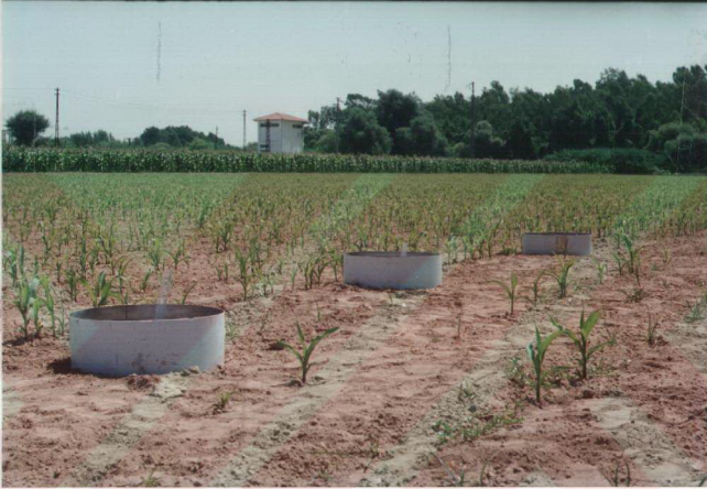
Şekil 3.4. Çift Silindirli İnfiltrometrelerin Arazide Kullanılışı
