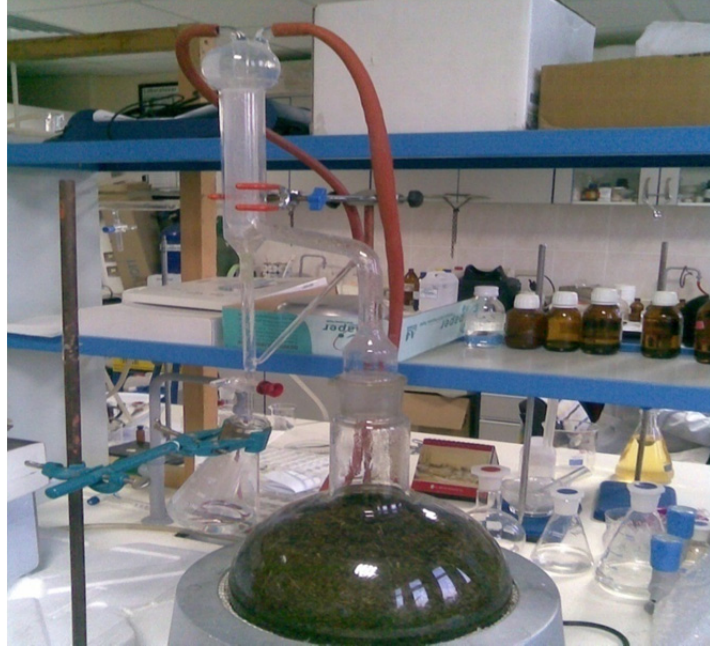
Şekil 6. Uçucu yağın cleveger aparatı ile elde edilmesi
