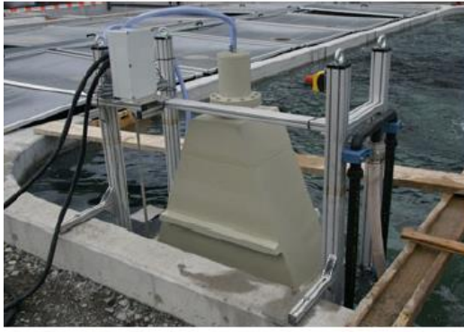
Şekil 1.2. Balık çiftliklerinde balıkların boyutlarını belirlemek için kullanılan gerçek zamanlı sistem ve kullanılan görüntü işleme düzeneği
