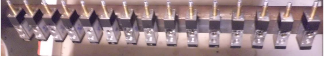
Şekil 3.8. İmal edilen hava kütüğüne selenoid valf montajı
