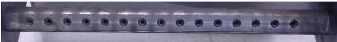
Şekil 3.7. Bilgisayar ortamında tasarlanan hava kütüğünün imal edilmesi
