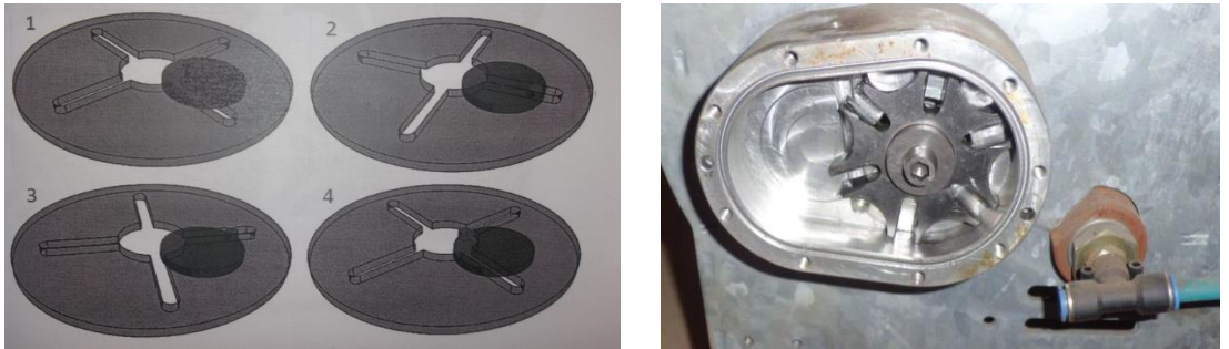
Şekil 3.13. Malta haçı mekanizması
