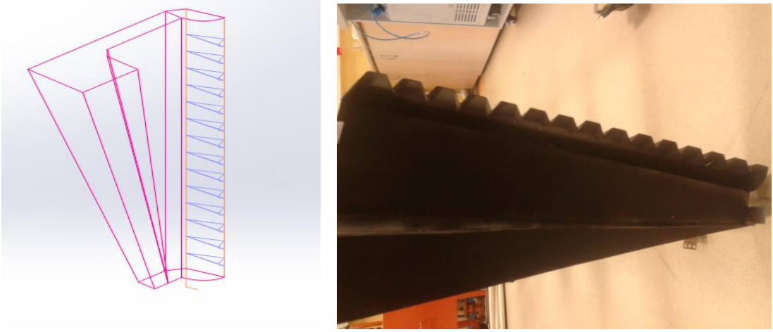
Şekil 3.14. Bilgisayar ortamında çizilen tırnaklı zeytin dağıtma mekanizması ve imalat resmi
