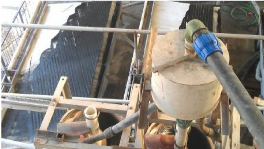
Şekil 4.5. Besleme Malının Ön Zenginleştirme Yapılarak Krebs Spiralleri + Sallantılı Masa Uygulamasından Bir Görüntü
