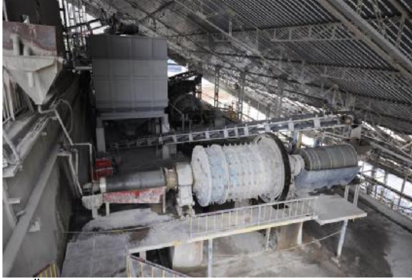
Şekil 4.6. Ara Ürün malzemesinin öğütüldüğü Bilyeli Değirmen
