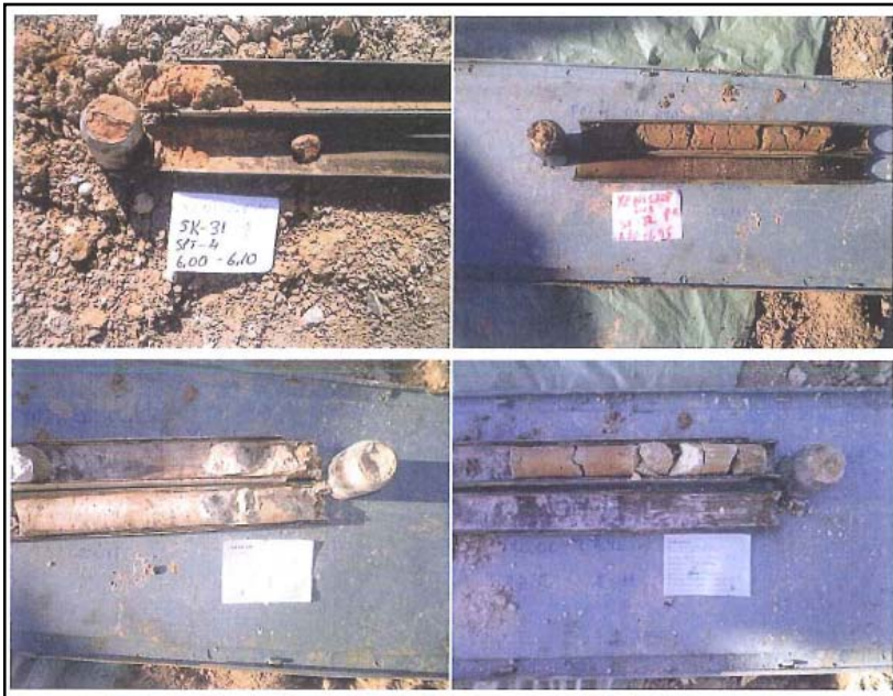
Resim 3.3. Dolgu, konglomera, kilitaşı ve kumtaşındaki yapılmış SPT'ler
