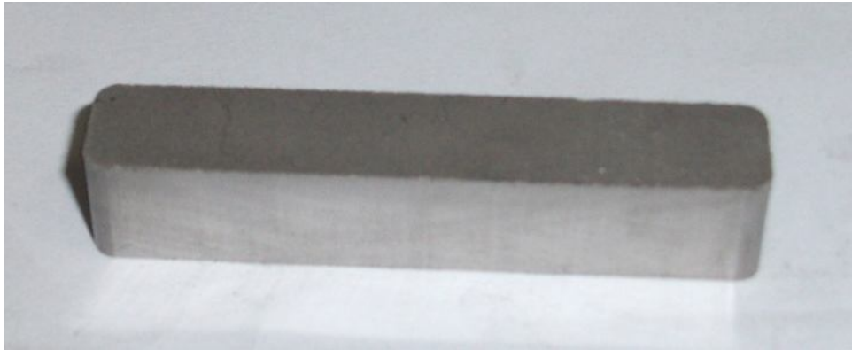
Şekil 4.3. 10x10x55 mm boyutlarında soğuk preslenmiş numune
