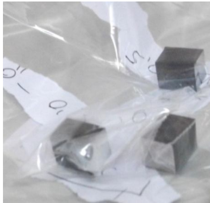
Şekil 4.17. Parlatma işlemi yapılmış 10x10x10 mm boyutlarındaki TM numuneler
