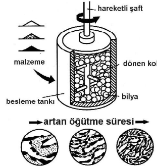
Şekil 2.4. Mekanik Alaşımlama Yöntemi (Zeren, 2013).
