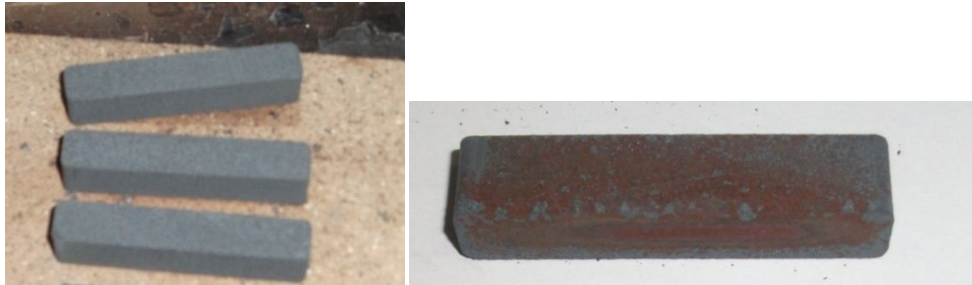
Şekil 4.11.a) İndüksiyon ile ön ısıtma yapılarak sinterlenen numuneler b) Ortam atmosferinde fırında sinterlenen numune
