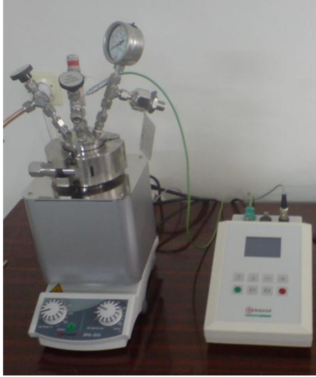
Şekil 3.4: Berghof BHL-800 modeli yüksek basınç otoklavı.
