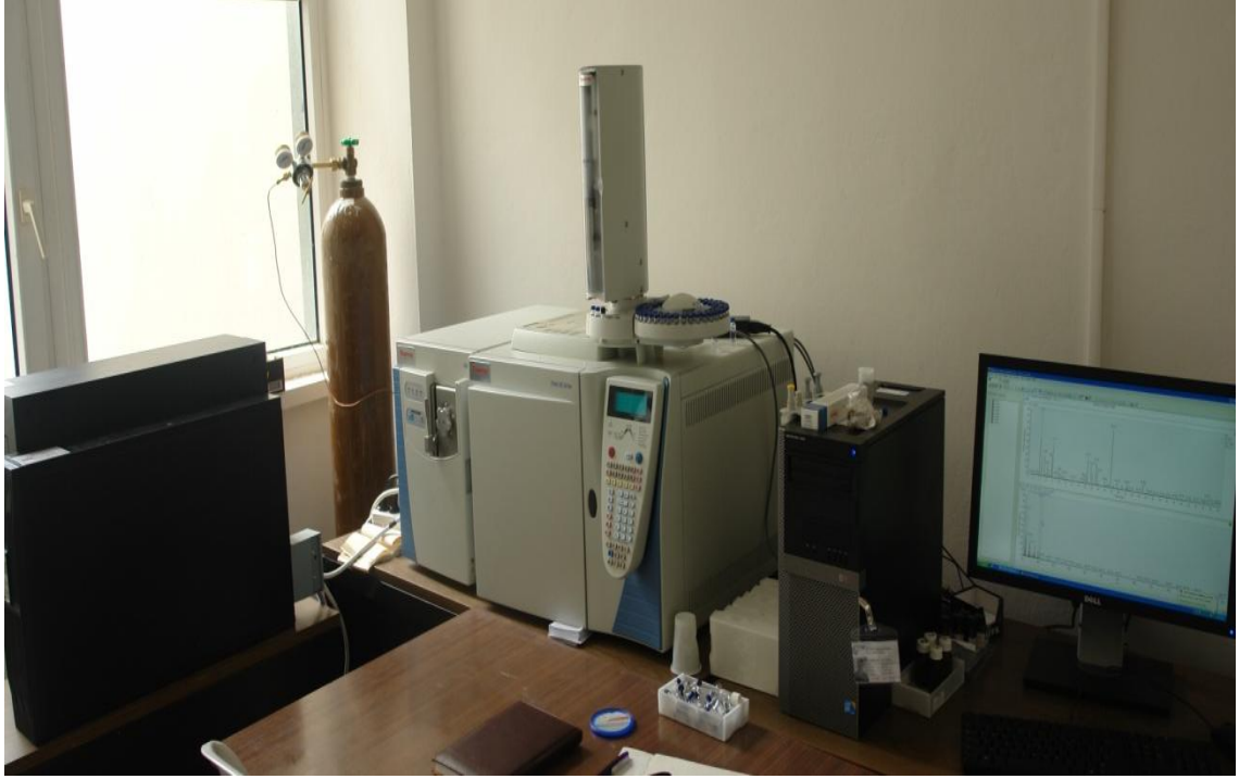
Şekil 3.3. GC/MS cihazında uçucu yağ bileşenlerinin analizi
