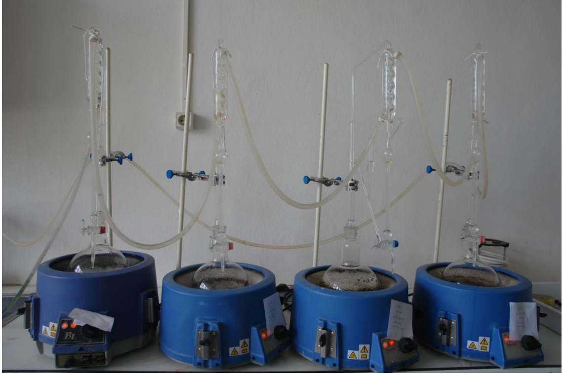
Şekil 3.2. Su buharı distilasyonu yöntemi ile uçucu yağ elde edilmesi
