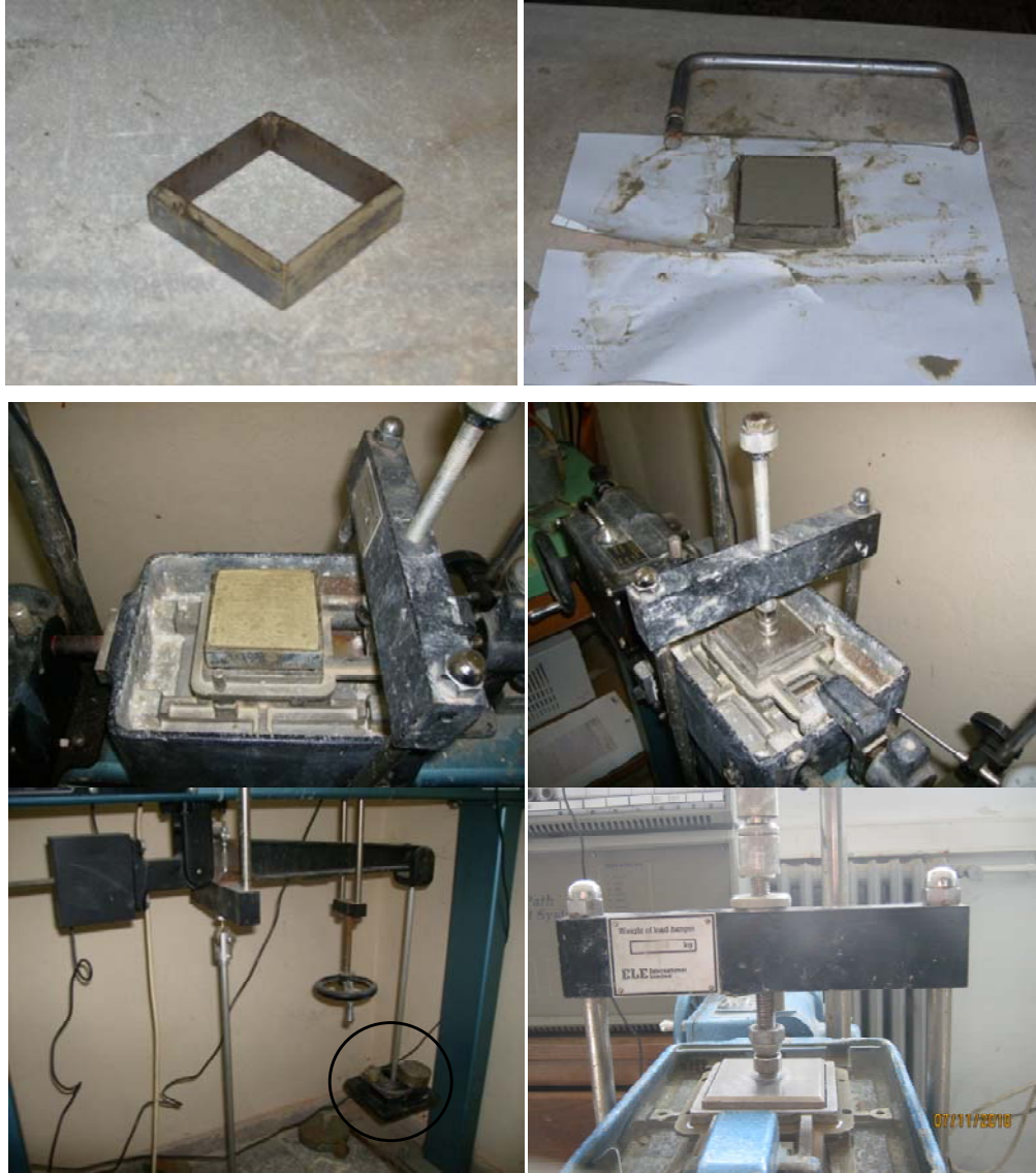
řekil 4.13: Numunenin kesme kutusuna yerleřtirilmesi, Kesme kutusu deneyinde konsol kol ve konsol kola yklemenin yapılması
