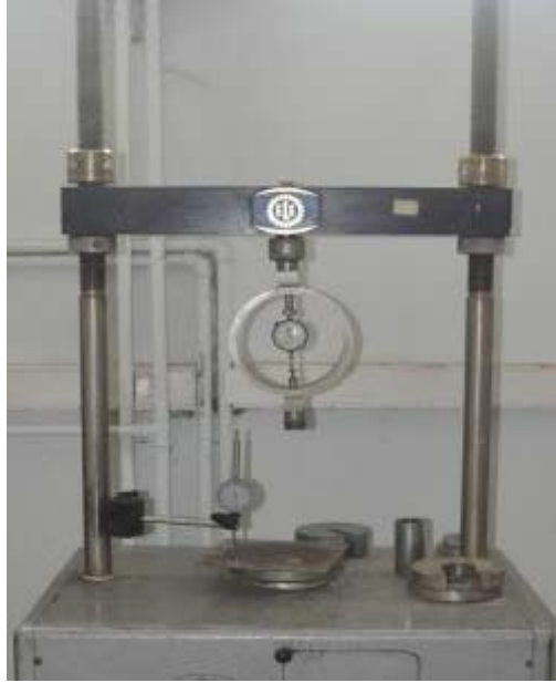
Şekil 2. 6: Serbest basınç deney aleti (İTÜ)
