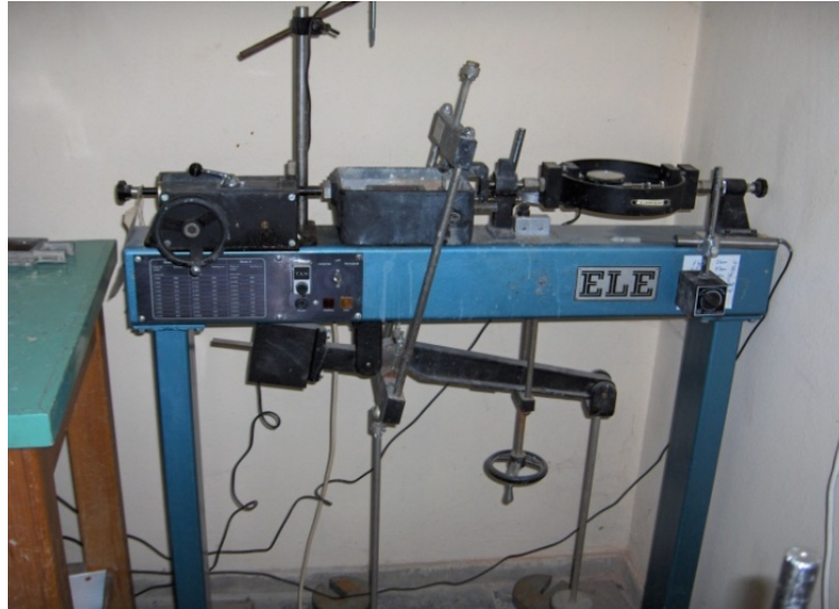
Şekil 3.9: Kesme kutusu deney aleti (İTÜ)
