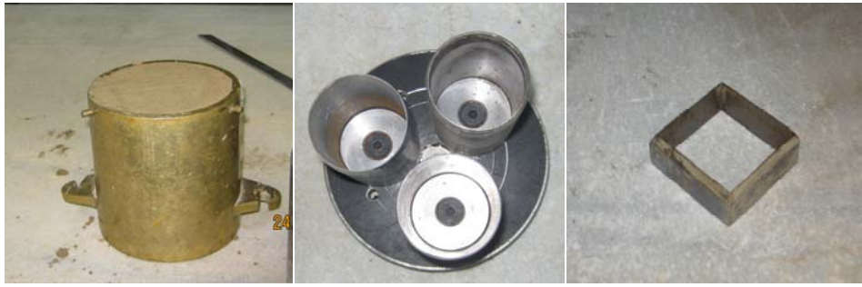
Şekil 4.2: Proktor kalıbı, konsolidasyonlu-drenajlı üç eksenli basınç deneyi ve tekrarlı kesme kutusu deneyi için numune kalıpları
