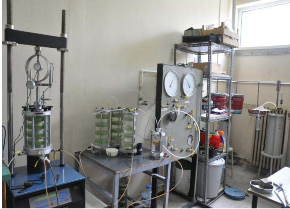
Şekil 4.3: Üç eksenli basınç deney sistemi
