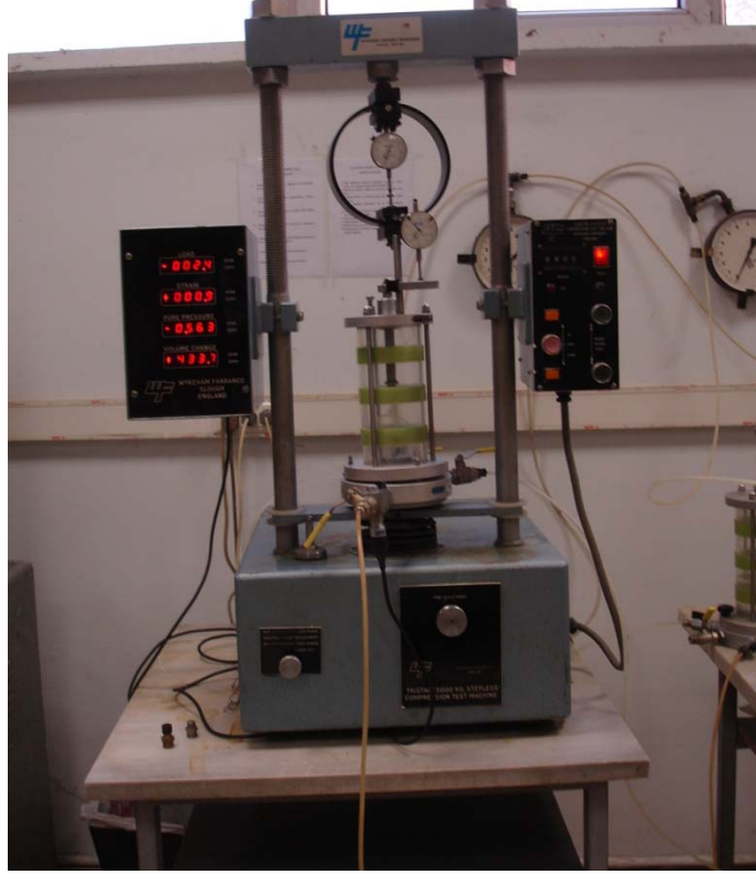
Şekil 3.8: Üç eksenli drenajlı deney aleti (İTÜ)
