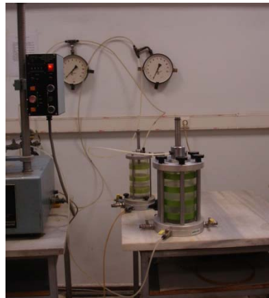
Şekil 4.5: Üç eksenli basınç deneyi ters basınç ve çevre basıncı hücresi
