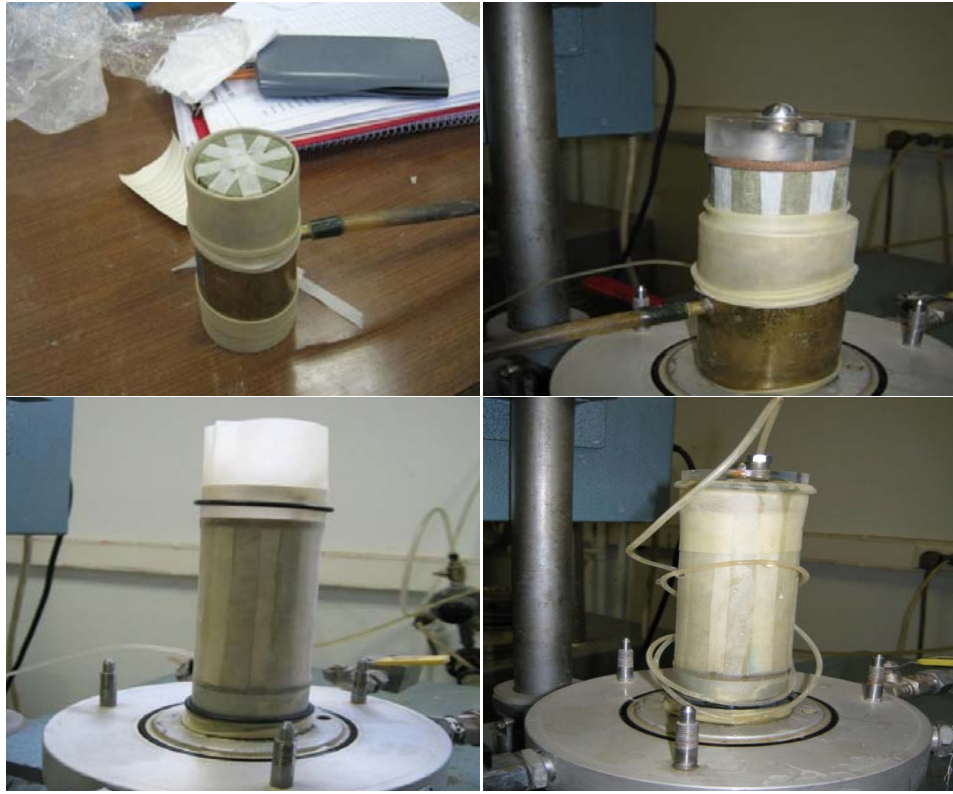
Şekil 4.8: Üç eksenli deney numunesinin hazırlanması
