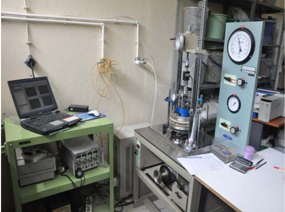
Şekil 3.10: Halka kesme deney aleti (İTÜ)
