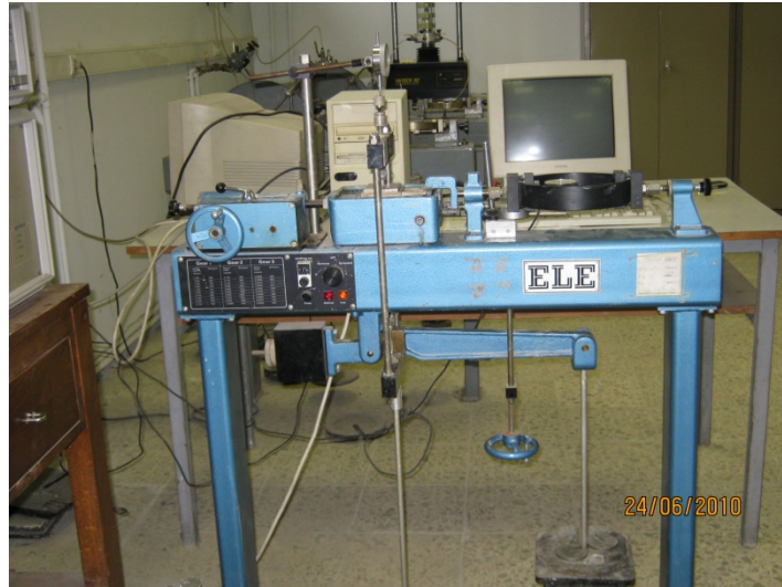
Şekil 2.7: Kesme kutusu deney aleti
