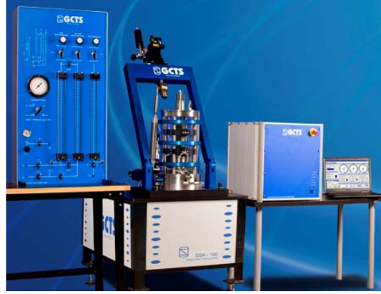
Şekil 2. 8: Basit kesme deney aleti (GCTS web sayfası)
