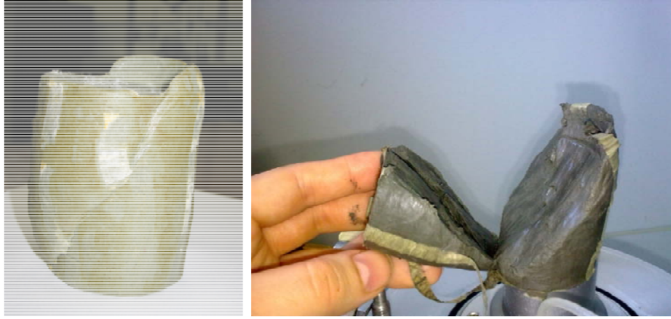
Şekil 4.9: Üç eksenli deney hücresinde kesilmiş numune
