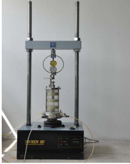
Şekil 2.9: Üç eksenli deney hücresi (İTÜ)
