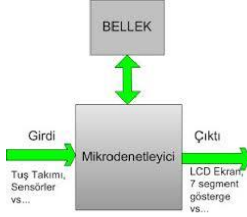
Şekil 3.1. Gömülü sistem yapısı
