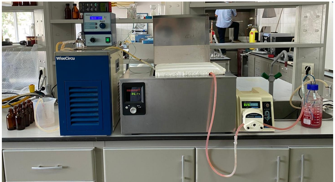
Azot gazı altında ısıtım işlemi düzeni-1
