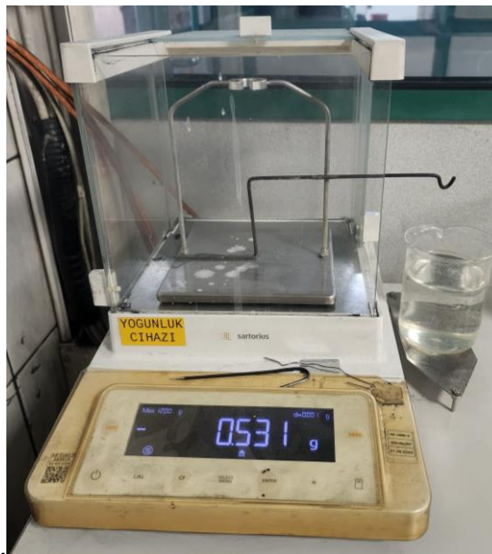
Şekil 3.9. Arşimet prensibine dayalı olarak çalışan yoğunluk ölçüm cihazı.
