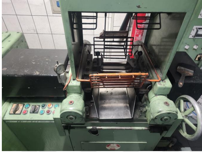
Şekil 3.2. İki silindirli açık karıştırma mili.
