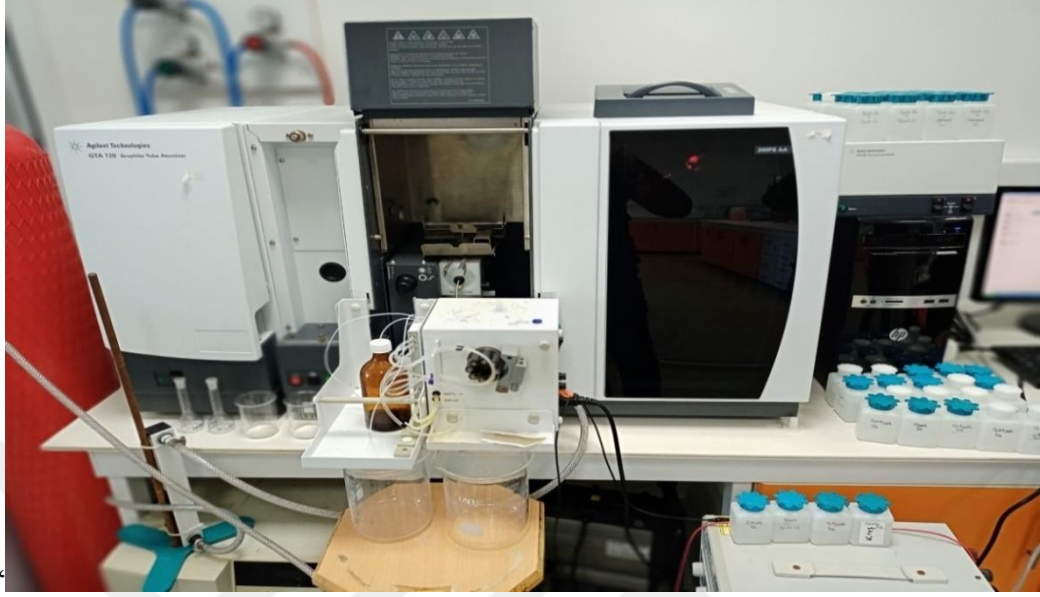
Şekil 2.7. Altın kaplı W-sarmal CV-AAS yönteminin genel görüntüsü
