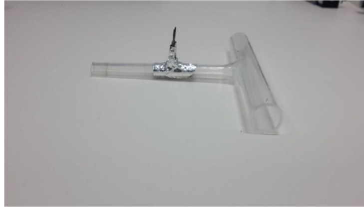
Şekil 2.5. W-sarmalın kuvars T-tüp atomlaştırıcıya yerleştirilmiş şekli
