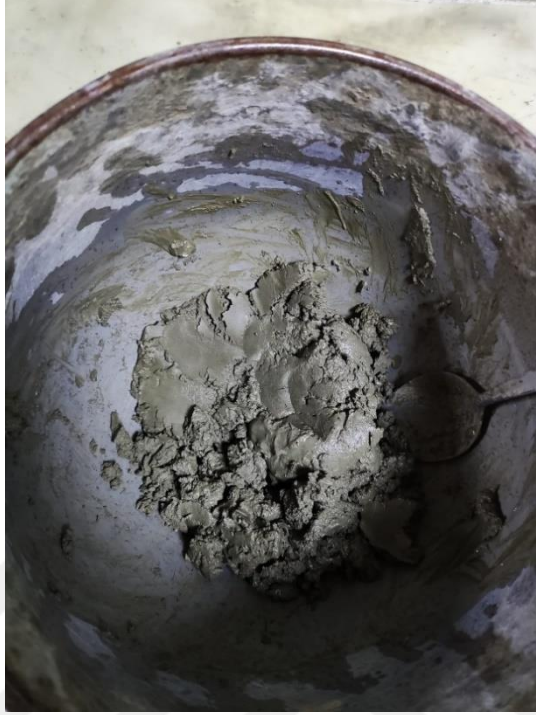
Şekil 4.6 0,3 S/Ç ve %4 katkıli hamurun karışım sırasında topaklanması (Kişisel arşiv, 2024)
