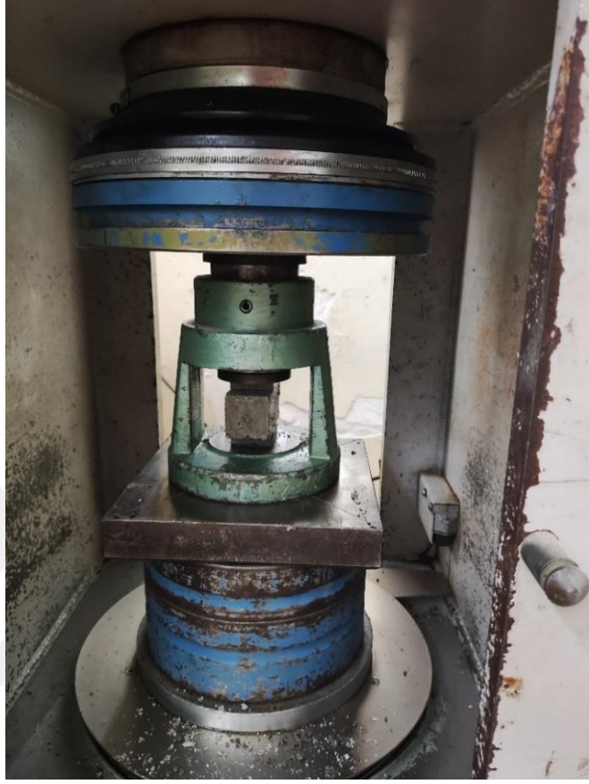
Şekil 3.15 Basınç makinesinde örneğin basınç altında bırakılması (Kişisel arşiv, 2024)
