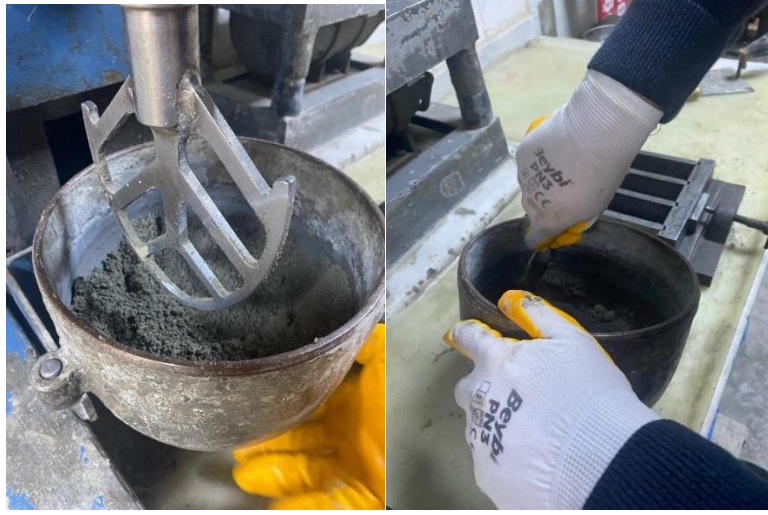
Şekil 3.4 Çimento harçlarının karıştırma işlemi (Kişisel arşiv, 2024)
