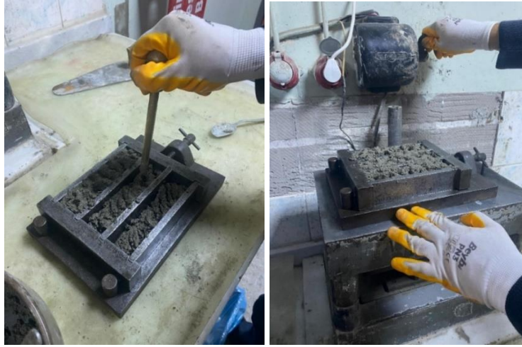
Şekil 3.5 Çimento harcının tokmaklanma ve dış vibrasyon işlemi uygulanması (Kişisel arşiv, 2024)
