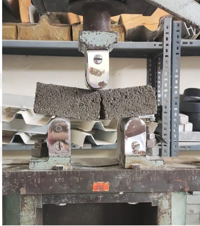
Şekil 3.14 3 noktalı eğilme dayanımı testi uygulaması (Kişisel arşiv, 2024)
