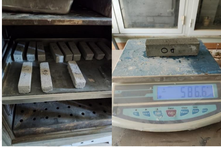
Şekil 3.13 Harçların kuruması için etüve atılması ve ağırlıklarının tartılması (Kişisel arşiv, 2024)
