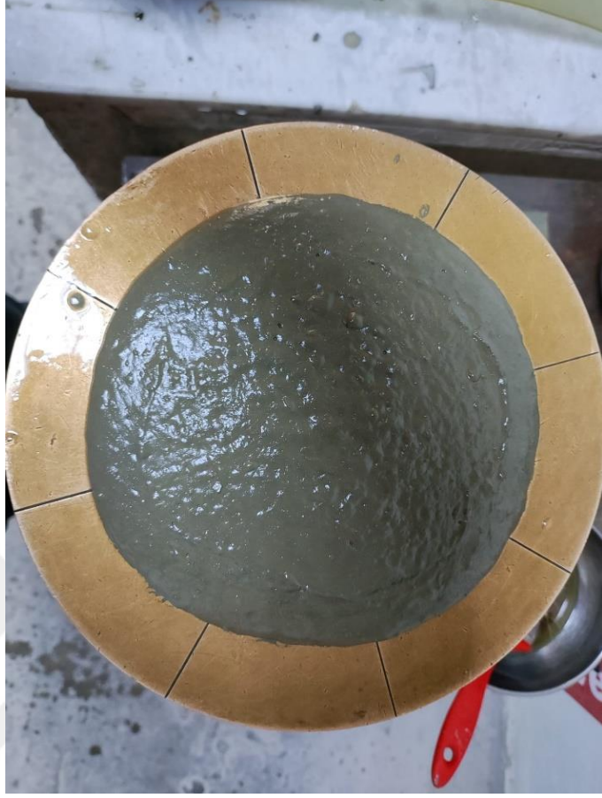
Şekil 3.8 Yayılma tablası deneyi sonucu yayılan hamur (Kişisel arşiv, 2024)
