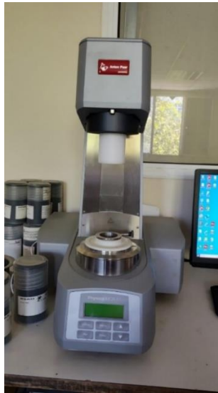
Şekil 3.10 Reoloji ölçümleri için kullanılan reometre (Kişisel arşiv, 2024)
