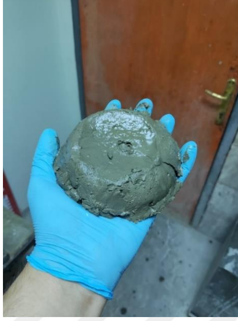
Şekil 4.4 0,5 S/Ç ve %2 karkılı harcın dökümden 5dk sonra ani katılaşması (Kişisel arşiv, 2024)
