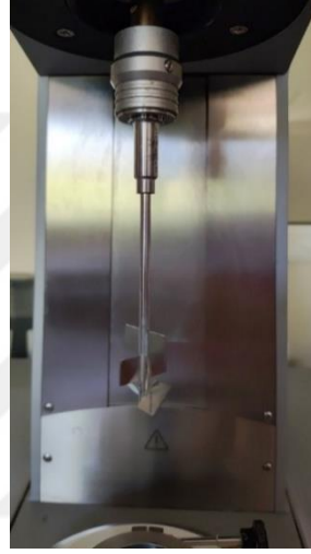
Şekil 3.9 Hamurun akma direncini ölçmek için reometreye takılan uç (Kişisel arşiv, 2024)
