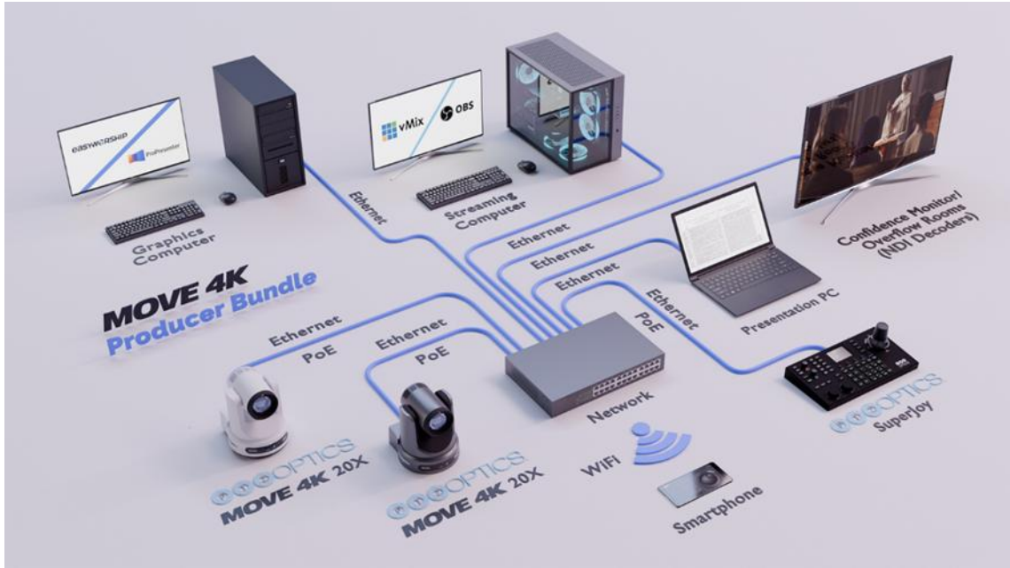
Şekil 16. PoE Ve Ethernet Altyapısıyla Çalışan PTZ Kamera Sistemi (PTZ Optics, 2025)
