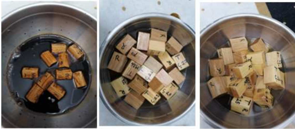
Şekil.4.2. Örneklerle daldırma yöntemiyle emprenye uygulanması
