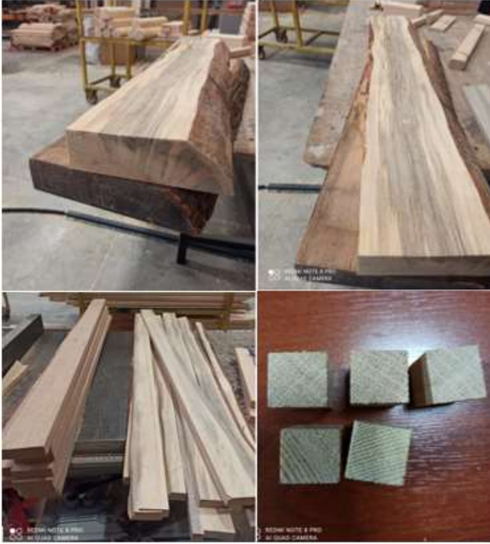
Şekil 4.1. Deney örneklerin hazırlanması
