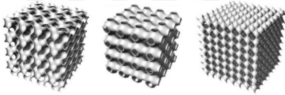
Şekil 2.5. ÜPMY kafes yapılar, a) girodial b) primitiv c) diamond (Yin vd., 2023)
