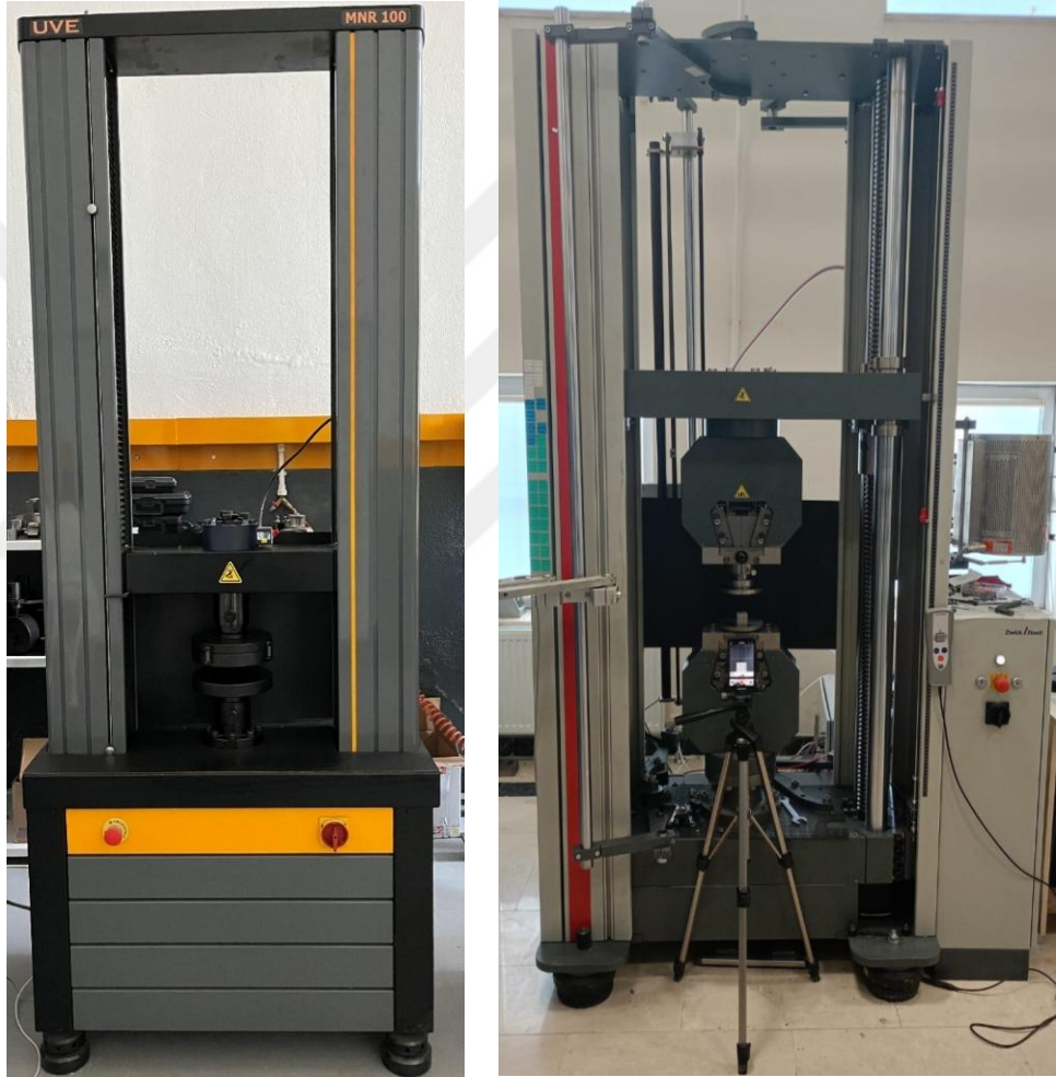
Şekil 3.15. UVE MNR100 100 kN (sol) ve Zwick Roell 300 kN (sağ) kapasiteli universal test cihazları
