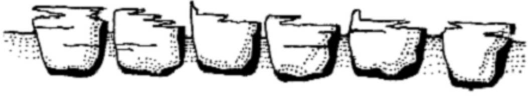
Şekil 5.9. Mozaikli yüzeylerde yapraklaşmayı ifade eden şekil
