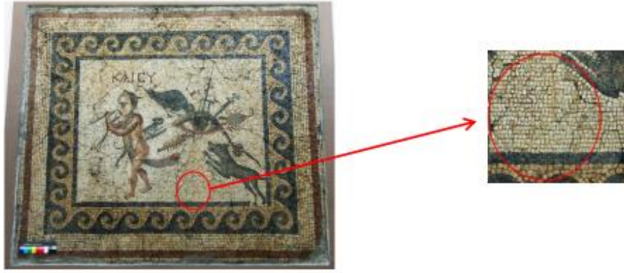
Resim 6.67. Yüzey koruyucu aplikasyonu uygulaması ve detayı
