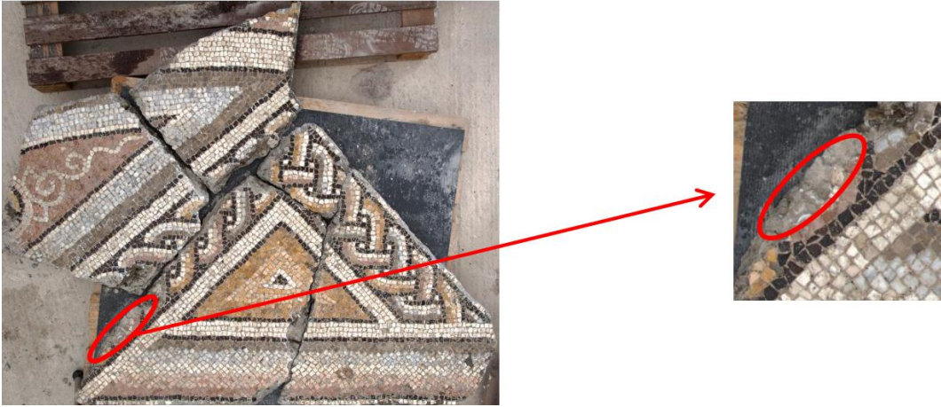
Resim 6.29. Çimento katkılı harç kullanımını ifade eden görsel
