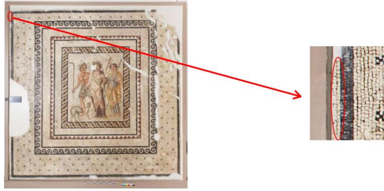
Resim 6.138. Tesselaların taşıyıcıdan ayrılması ve detayı
