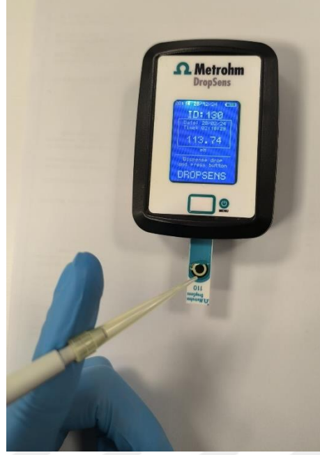
Şekil 3. 6 DropStat ile yapılan elektrokimyasal ölçümler
