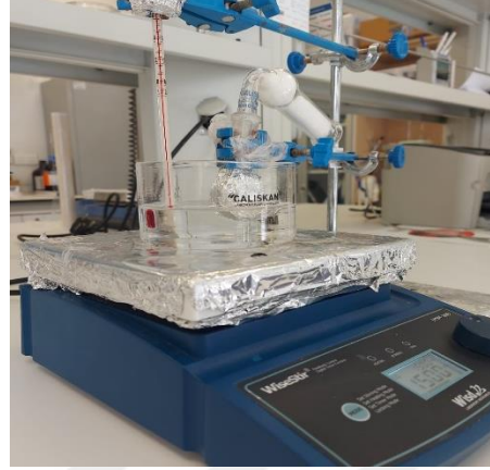
Şekil 3. 7 DES çözeltilisinin hazırlanmasında kullanılan düzenek
