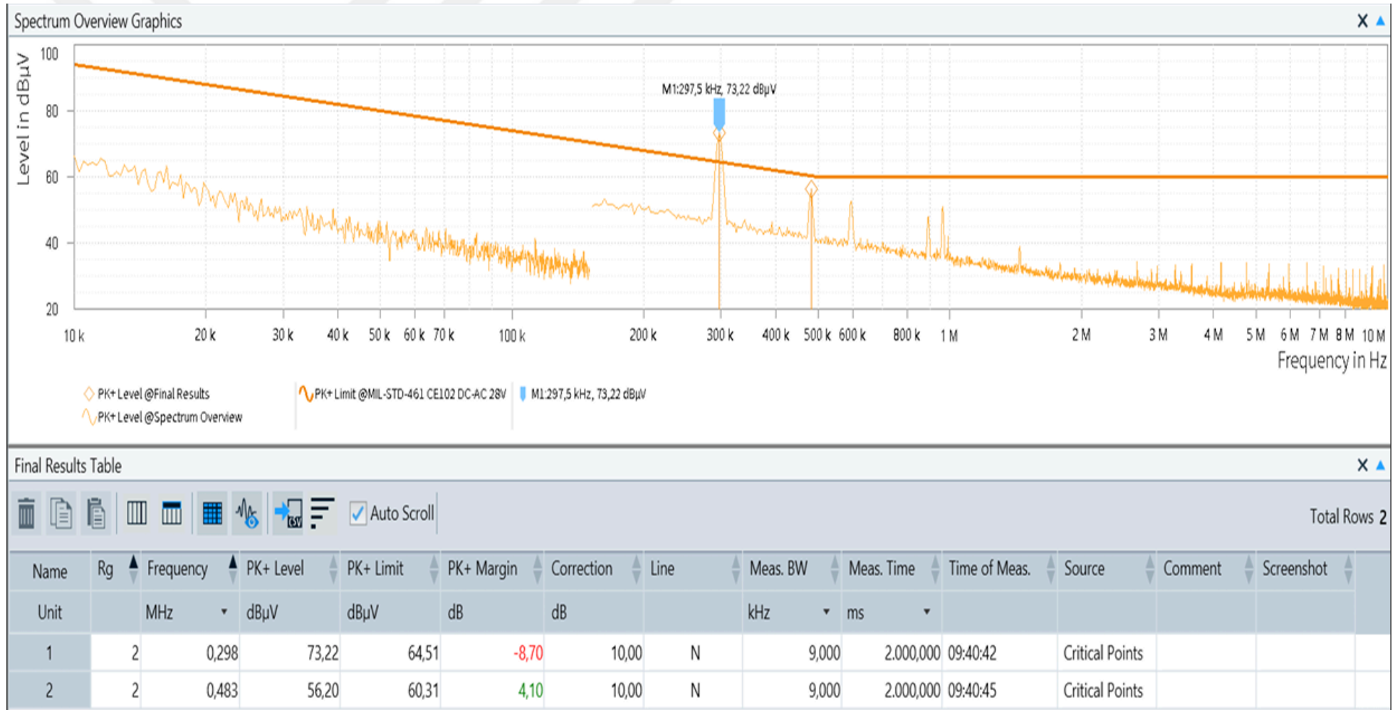
Şekil 4.5: Birincil Filtre CE102 Testi Sonuç Grafiği 1. Frekans
