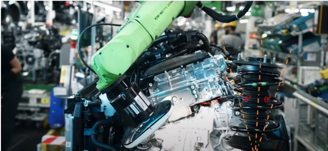
Şekil 2.4. Seri üretim parçası üzerinde \pm 6^\circ pozisyon değişikliği örneği [88].
