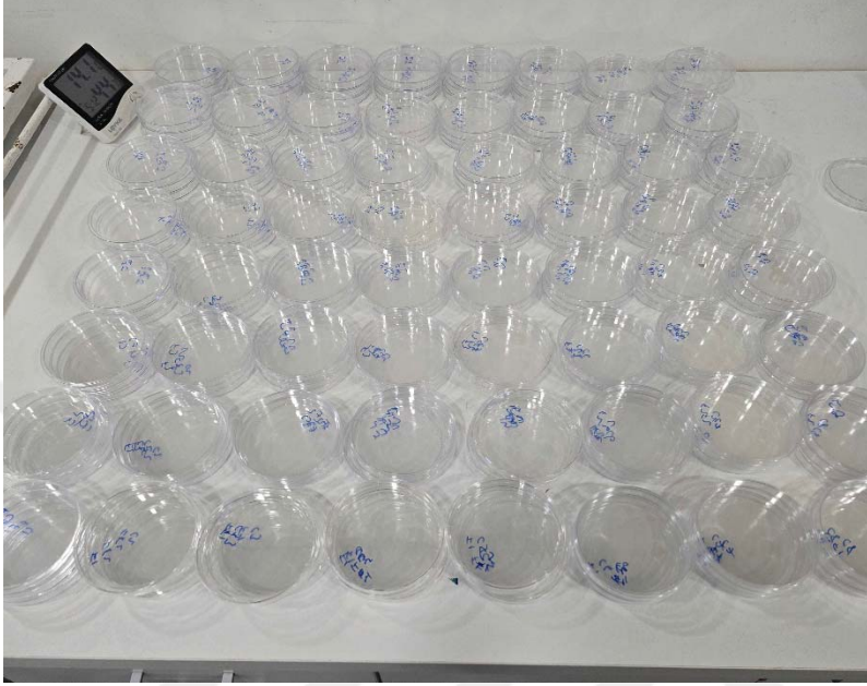
Şekil 7. Besiyeri hazırlanması sırasında boş steril petri kaplarının işaretlenmesi (8x8 agar dilüsyon temelli dama tahtası yöntemi)
