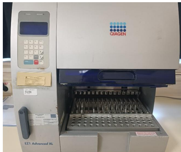
Şekil 24:EZ1 Advanced XL model ekstraksiyon cihazı
