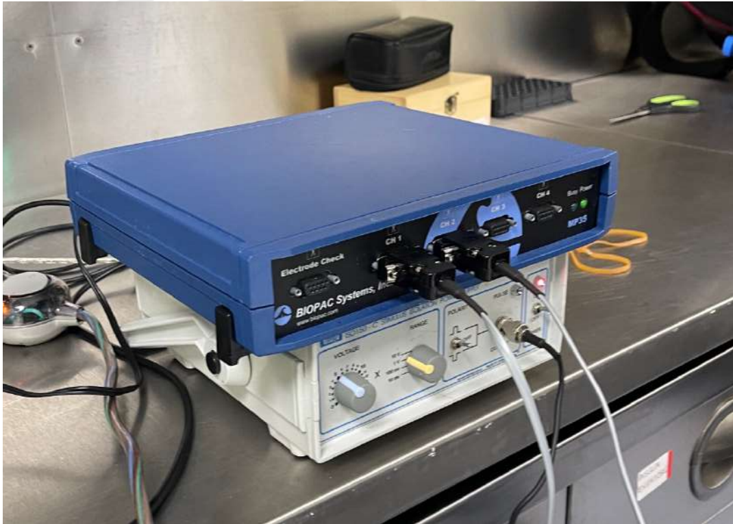
Şekil 22. Üstte mavi Güçlendirici Ünite ve Veri Toplama Modülü. Altta stimülatör cihazı.
