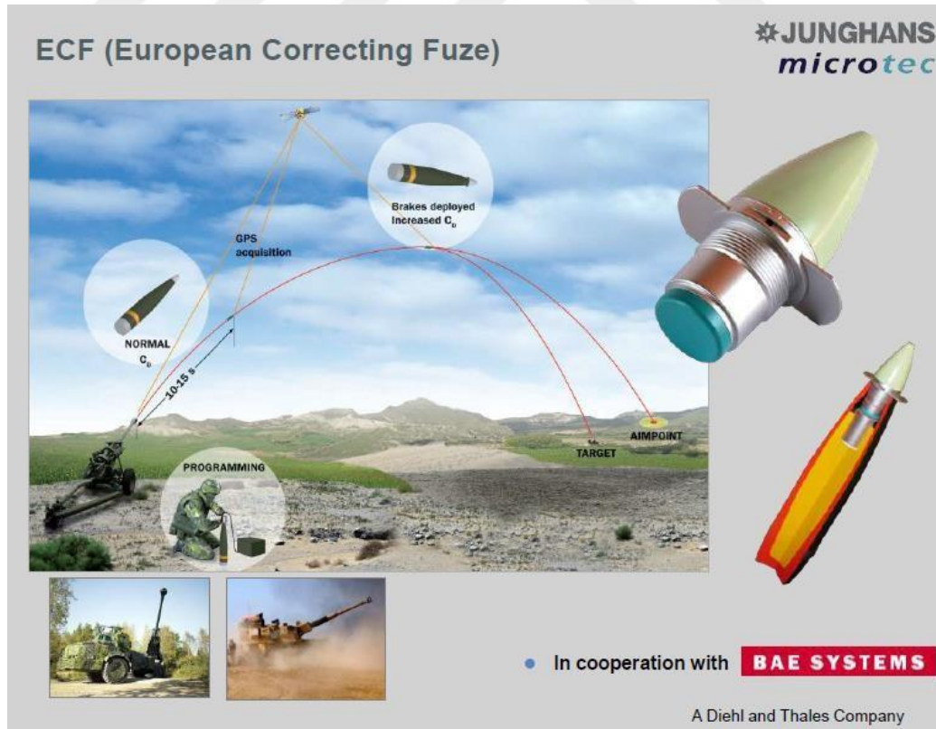
Şekil 2.23. Yörünge düzeltmeli tapa (GPS) çalışma şekli gösterimi [83]
