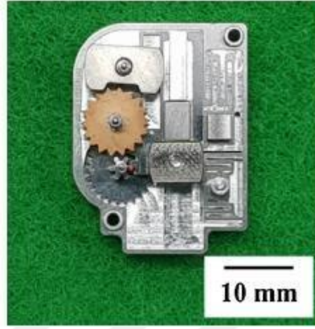
Şekil 1.3. Minyatür güvenlik kurma mekanizması [8]
