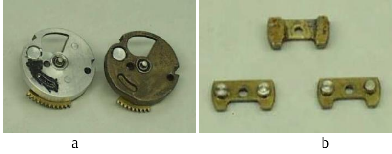
Şekil 1.30. Modifiyeli-modifiyesiz rotor (a) ve pandül (b) [37]
