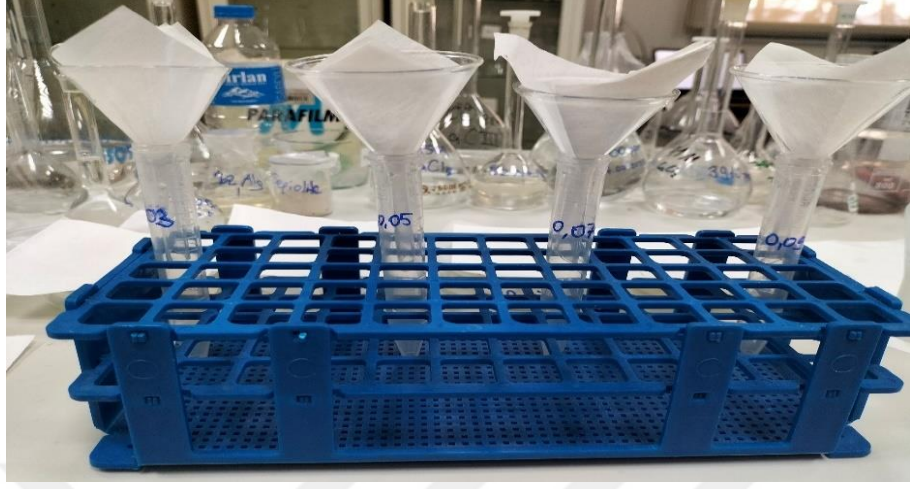
Şekil 3.5 Süzme işlemi örneği
