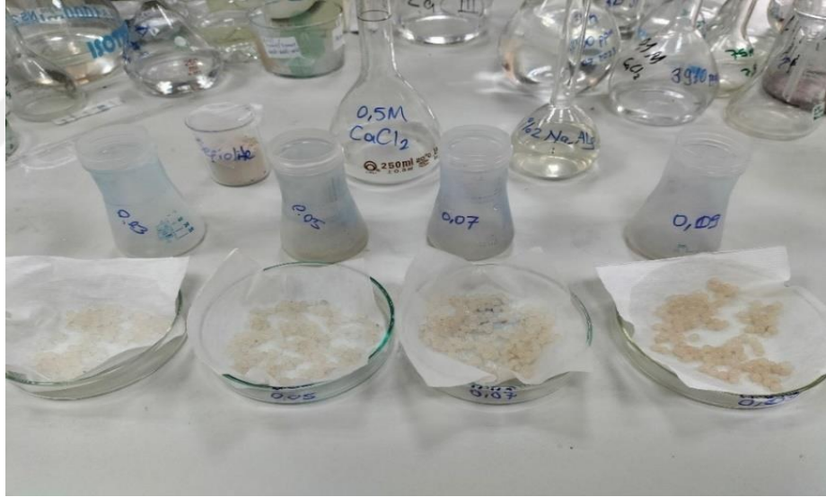
Şekil 3.4 Islak hidrojel kürecikler.
