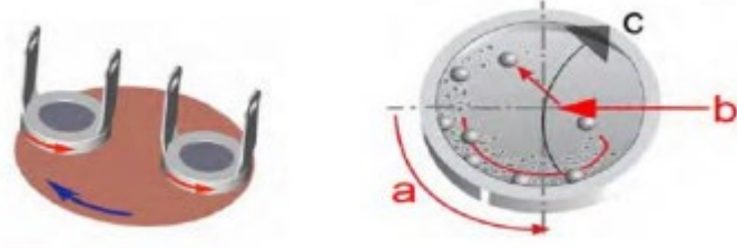
Şekil 3.7. Öğütme haznesinin ve bilyelerin hareketi [77]
