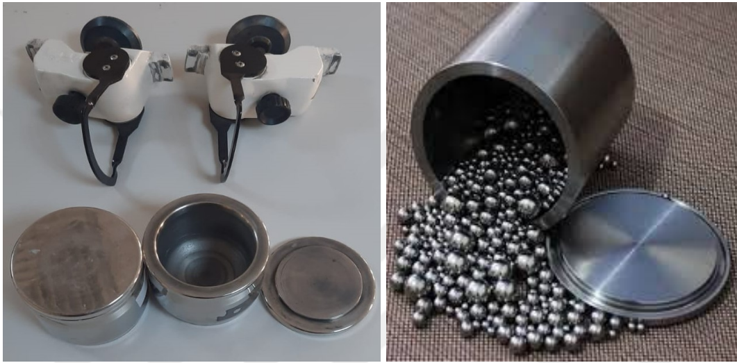
Şekil 3.5. Öğütme havanı iç kısmı, havan, mekanik alaşımlama havan kilit parçası ve bilyeler
