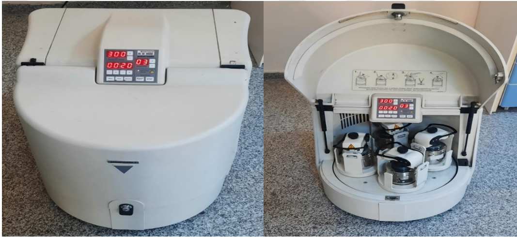
Őekil 3.2. Fritsch Pulverisette 5 Marka Mekanik Alařımlama Cihazı dıř ve i kısmının grnts
