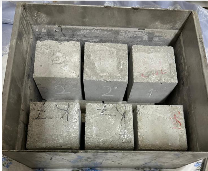
Şekil 3.15: Kılcal su emme deney düzeneği
