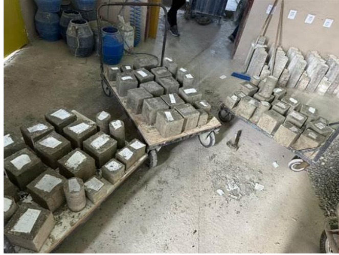
Şekil 3.3: Kalıptan çıkmış beton örnekler
