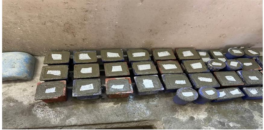
Şekil 3.2: Taze betonun kalıplardaki son hali
