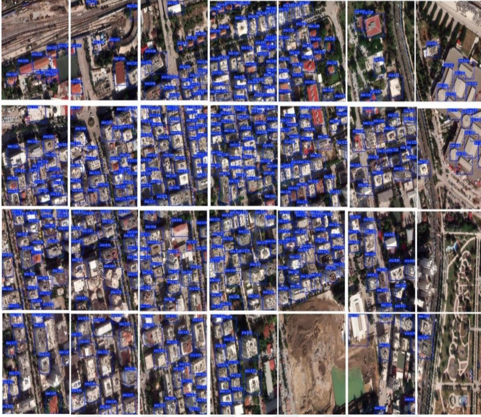
Şekil 5.22 Çalışma alanı 2 YOLOv8 bina tespiti
