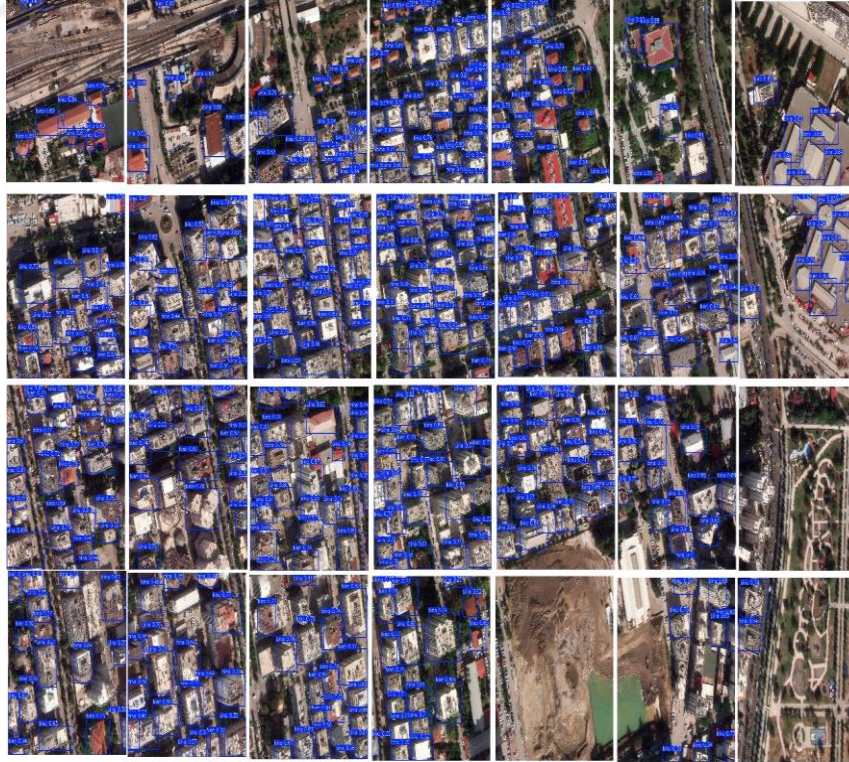
Şekil 5.28 Çalışma alanı 2 YOLOv11 bina tespiti
