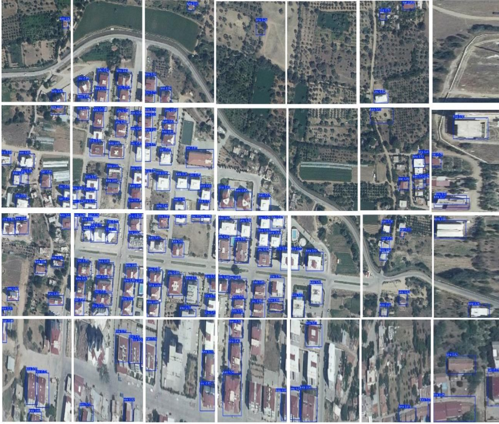
Şekil 5.14 Çalışma alanı 1 YOLOv11 bina tespiti
