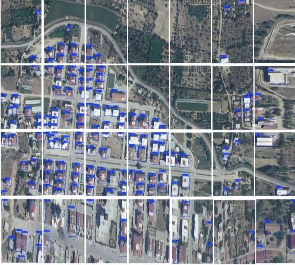
Şekil 5.8 Çalışma alanı 1 YOLOv8 bina tespiti
