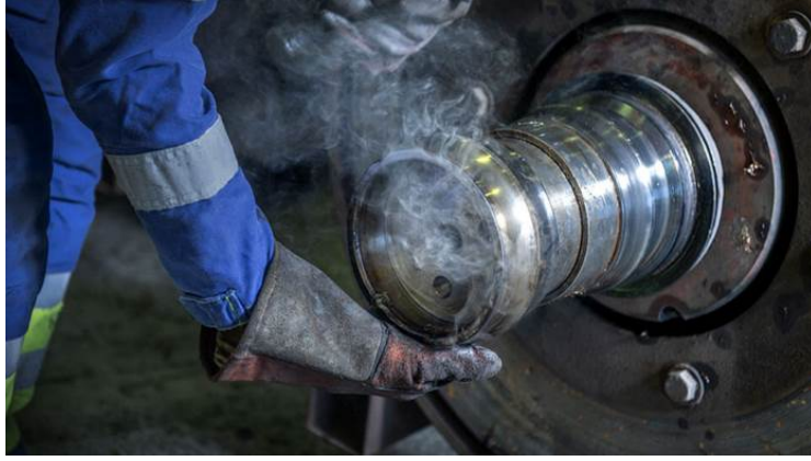
Şekil 1.2 Isıtılarak monte edilen sıkı geçme rulman iç bileziği [4]
