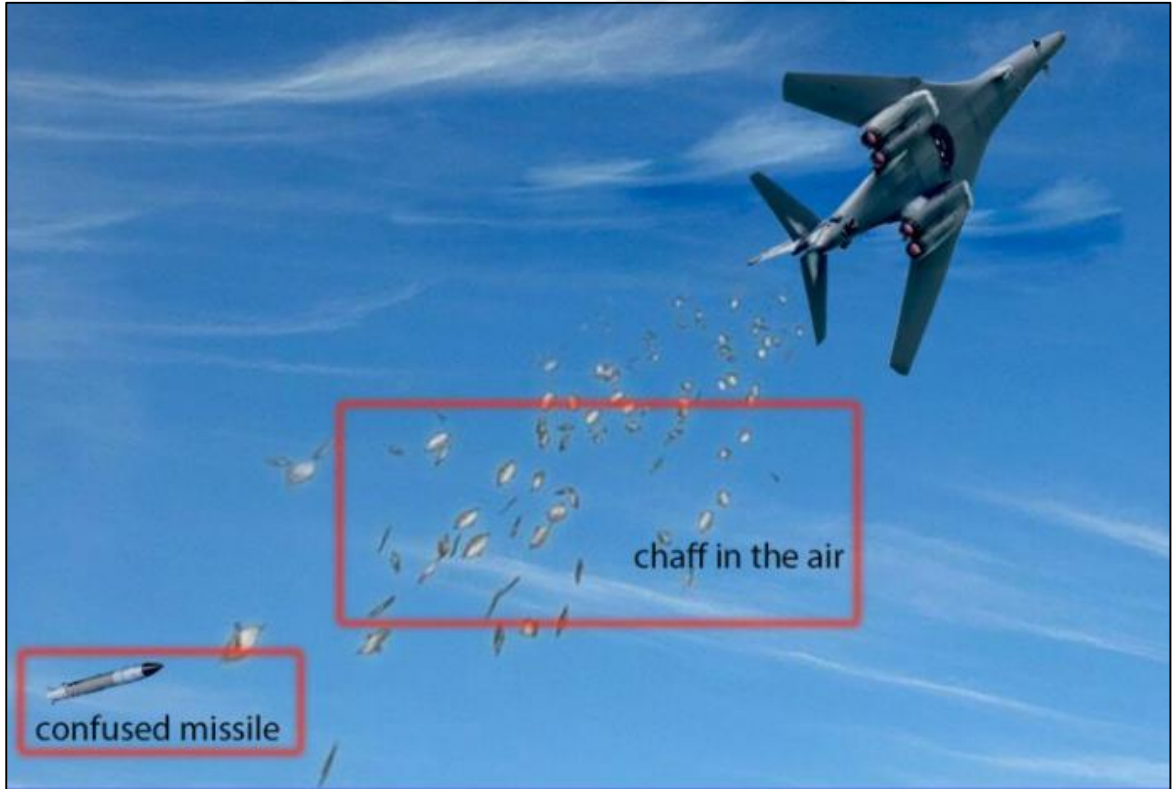
Şekil 1.3. Pasif mühimmatla hava ortamında füze yörüngesini şaşırtma [29]
