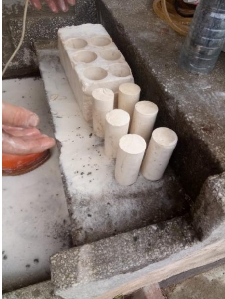
Resim 3.5. Camiden alınan karot numuneleri
