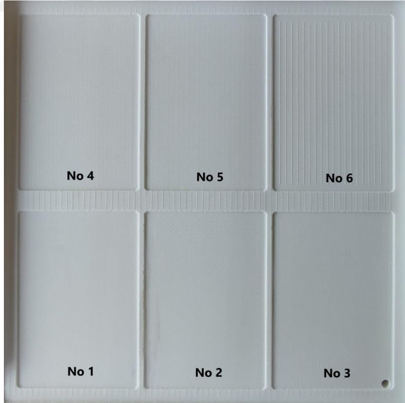
Resim 4.3 MARB mermer kesme genişliğine göre yüzey görüntüsü.
