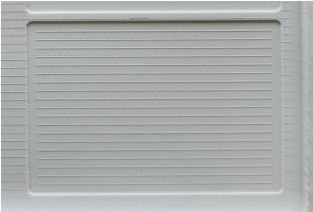
Resim 4.1 Tam kesim ile frezelenmiş yüzey.
