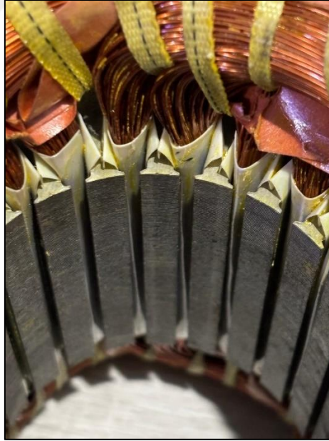
Şekil 4.28. Volt electric motors VM 90L-2 motor stator oluk yapısı görünümü
