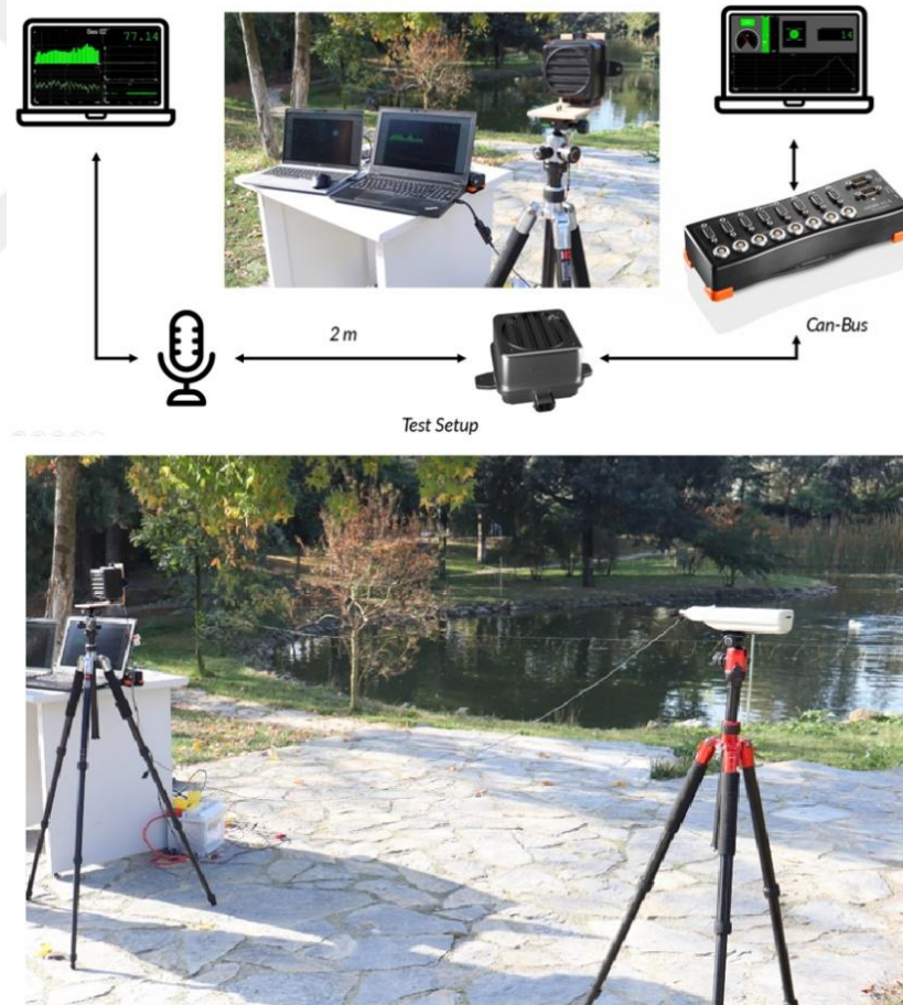
Şekil 5.1. UNECE-R138 regülasyonları göre ses seviyesi test ayarı.
