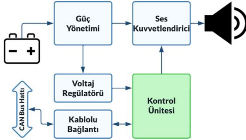
Şekil 4.1. AVAS elektronik tasarım blok diyagramı.
