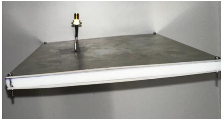
Şekil 4.1. Üretilen Antenin Yandan Görünüşü
