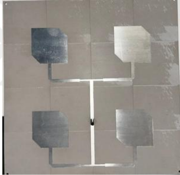
Şekil 4.3 Üretilen Dizi Antenin Üst Görünüşü
