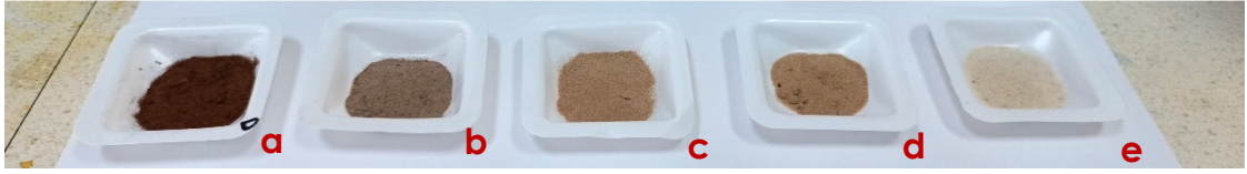
Şekil-3.6. Y-2-rRDX dijital fotoğrafları (a) ön saflaştırma işlemleri öncesi, (b) kloroform (50 °C) (c) kloroform (oda sıcaklığı) (d) diklorometan (oda sıcaklığı) ve (e) piritin (oda sıcaklığı)
