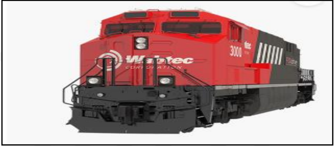
Şekil 2: Wabtec Dünyanın İlk % 100 Elektrikli Ağır Yük Lokomotifi
