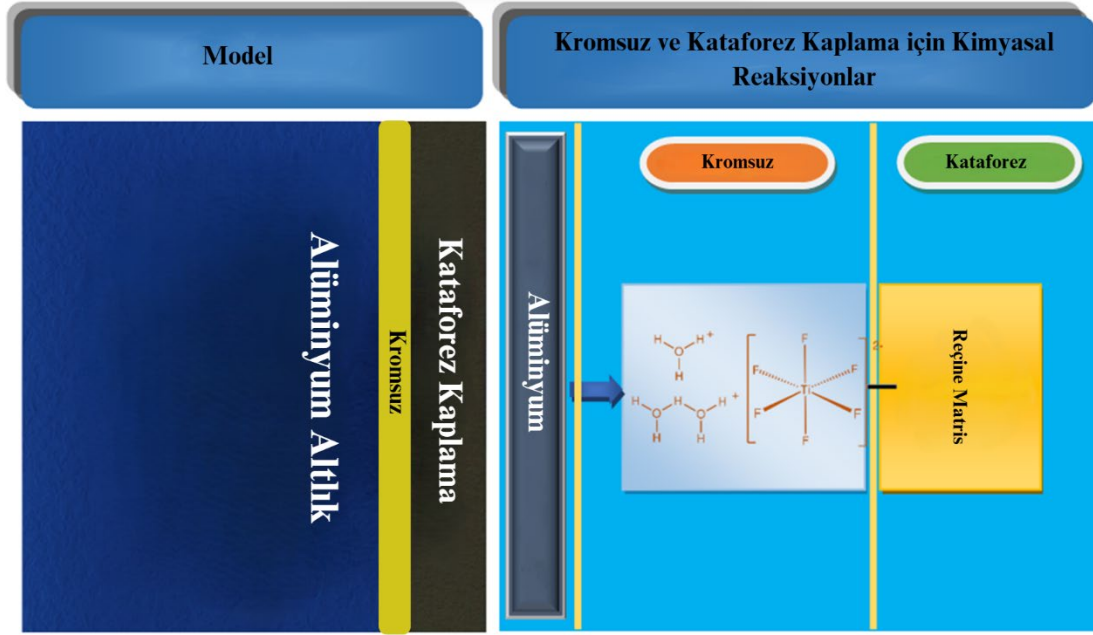
Şekil 8.2. Alüminyum, kromsuz ve kataforez kaplamanın kesit modeli.
