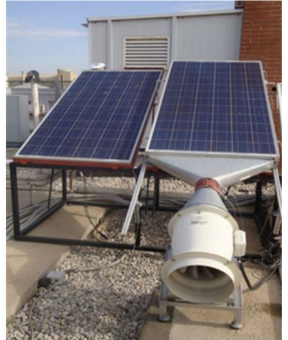
Şekil 8. PV hücrelerin hava akışkanını kullanılarak soğutulduğu aktif bir soğutma yöntemi (Mazón-Hernández et al., 2013).
