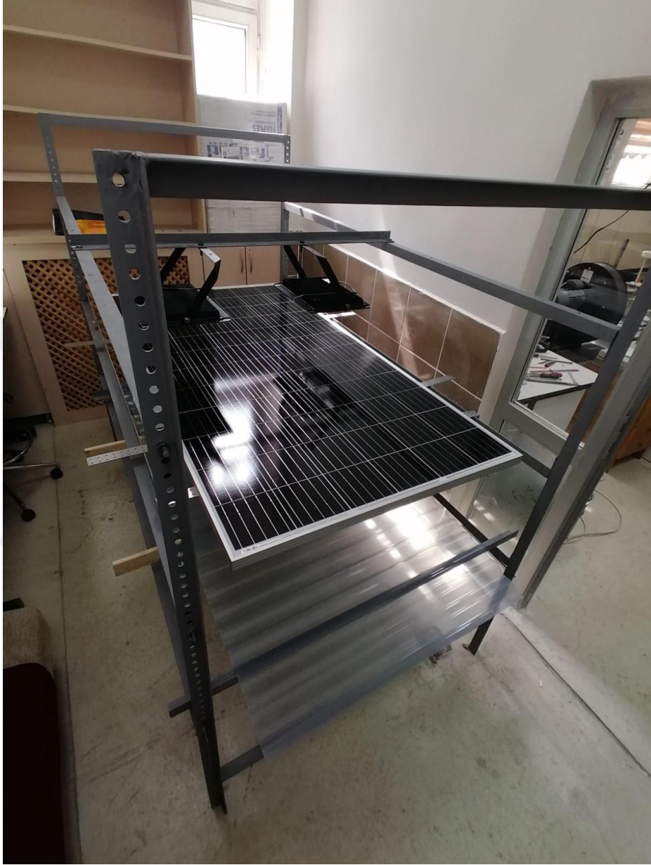
Şekil 26. Demir standın üzerine PV panel, çatı malzemesi ve projektörlerin yerleştirilmesi.
