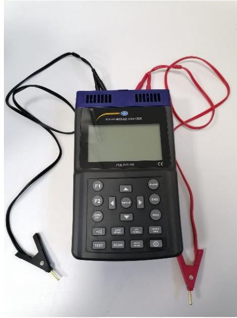
Şekil 20. Güneş modülü güç ölçüm cihazı.
