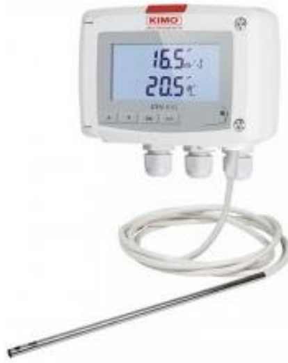
Şekil 23. Deneylerde kullanılan Anemometre (Hız ölçüm cihazı).
