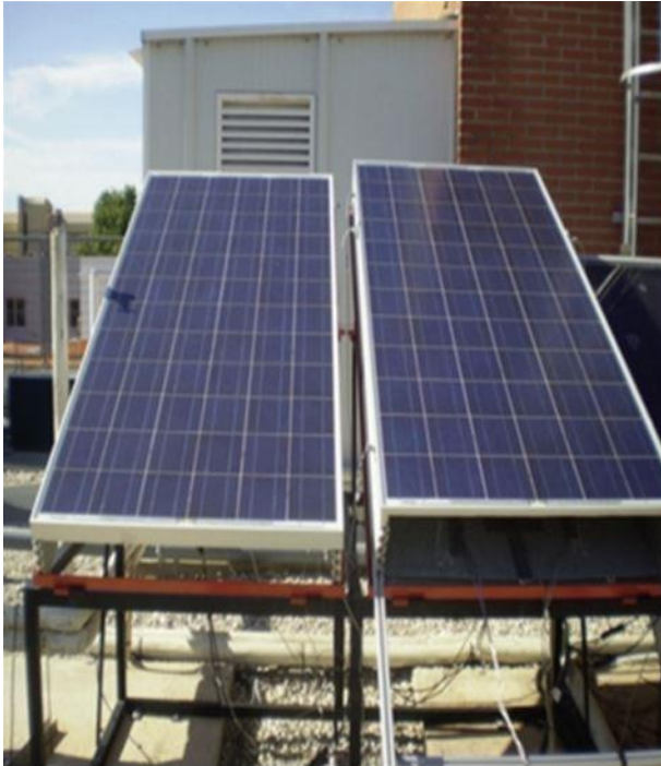
Şekil 8. PV hücrelerin hava akışkanını kullanılarak soğutulduğu aktif bir soğutma yöntemi (Mazón-Hernández et al., 2013).
