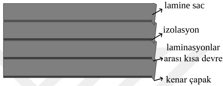
Şekil 3.19. Sac yığını üzerindeki kenar çapaklarından kaynaklanan laminasyon kısa devre arızaları
