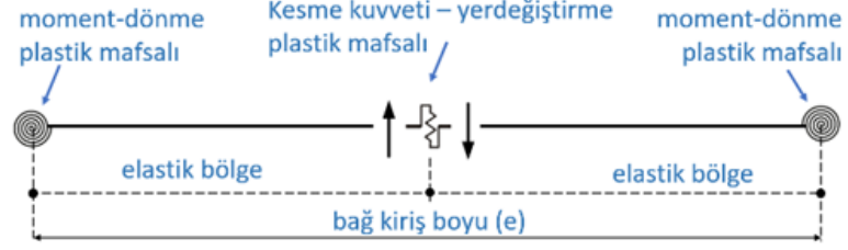
Şekil 3.4 : Bağ kirişi analitik davranış modeli.
