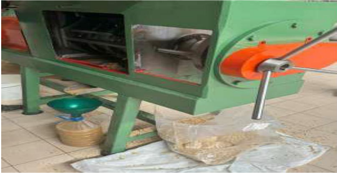
Şekil 3.1. Soğuk sıkım işlemiyle fındıklardan yağın uzaklaştırılması
