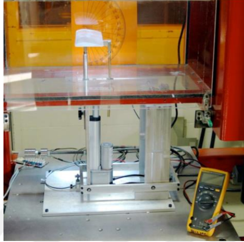
řekil 2.11 : İki bileřenli kuvvet-denge mekanizması rneęi (Morris ve Post, 2010).
