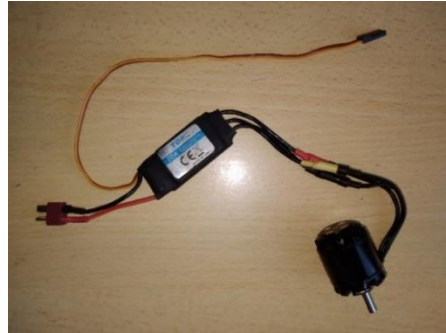
Şekil 2.2 : Fırçasız DC elektrik motoru ve elektronik hız kontrol devresi.
