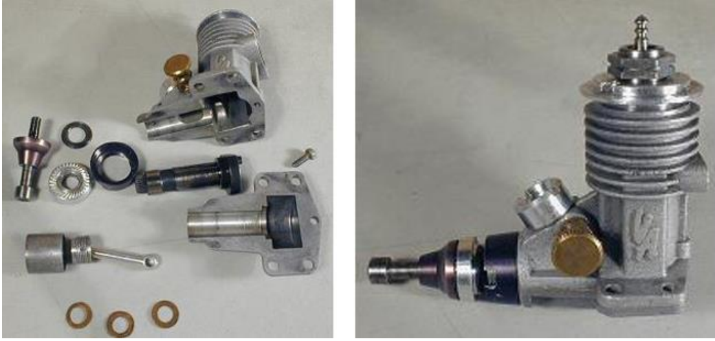
Şekil 1.6 VA-049-Mk1 motoru ve iç yapısı [14].
