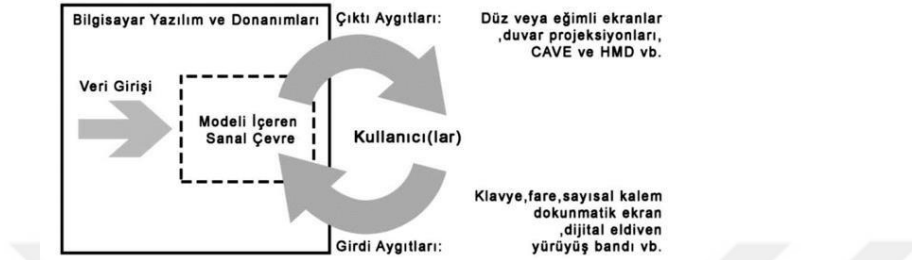
Şekil 2.4 Sanal gerçeklik sistemlerinin temel bileşenleri (Whyte, 2002: 13)
